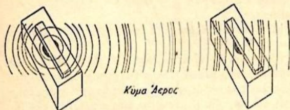
Σχ. 10. Δύο διαπασόν πὸν δείχνουν πῶς τὰ κύματα τοῦ ἀέρος, πὸν προκαλεῖ τὸ πρῶτο διαπασόν, χτυποῦν τὸ δεύτερο διαπασόν καὶ τὸ θέτουν σὲ παλμικὴ κίνησι.
